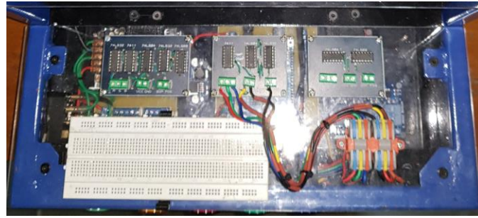
Gambar 4. Rangkaian pengendali mesin sortir berupa rangkaian Karnaugh Map (atas) dan Arduino Uno serta rangkaian elektrik lainnya (di bawah/di dalam kerangka mesin)
